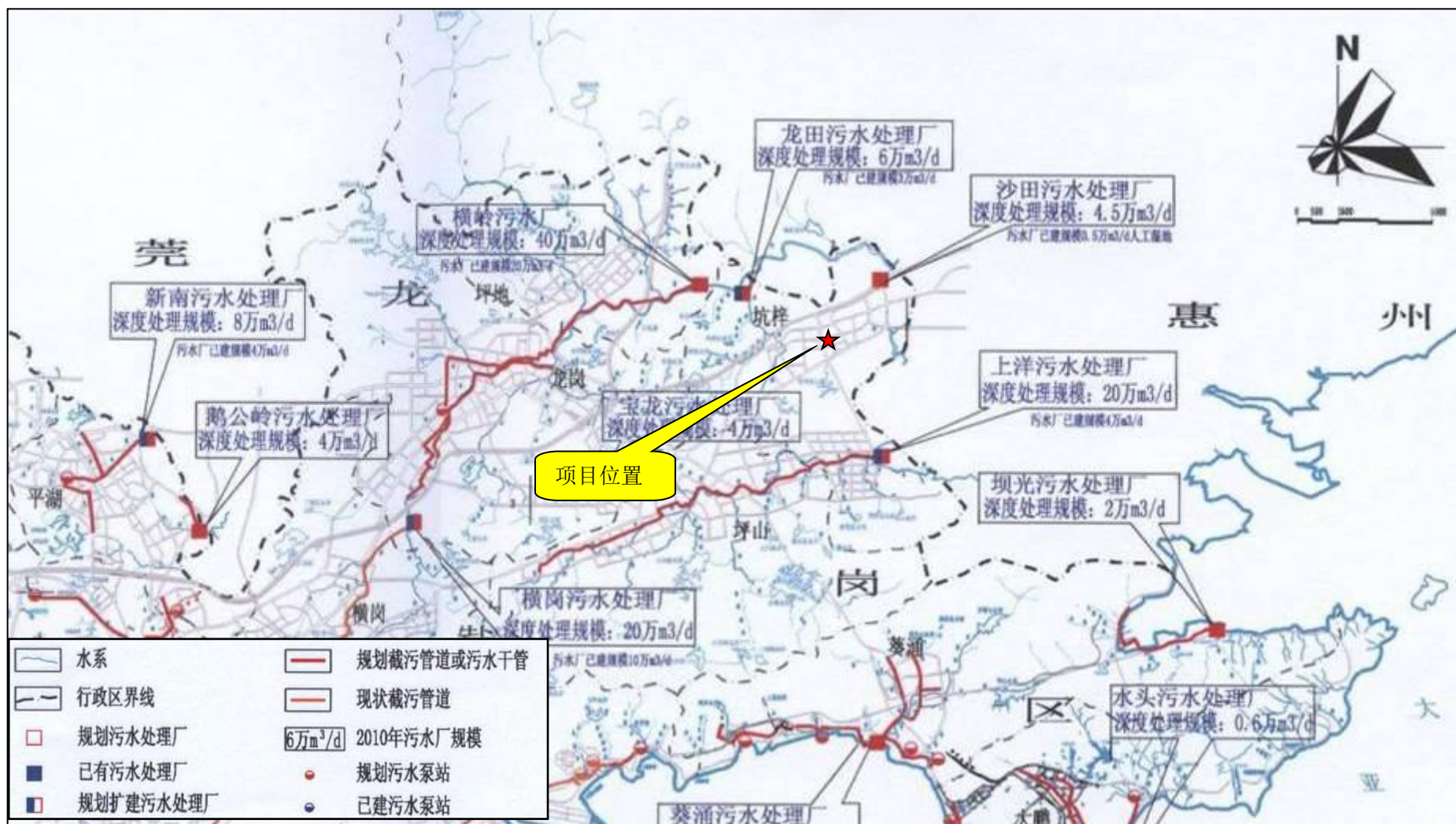
附图9 项目所在区域污水管网图
